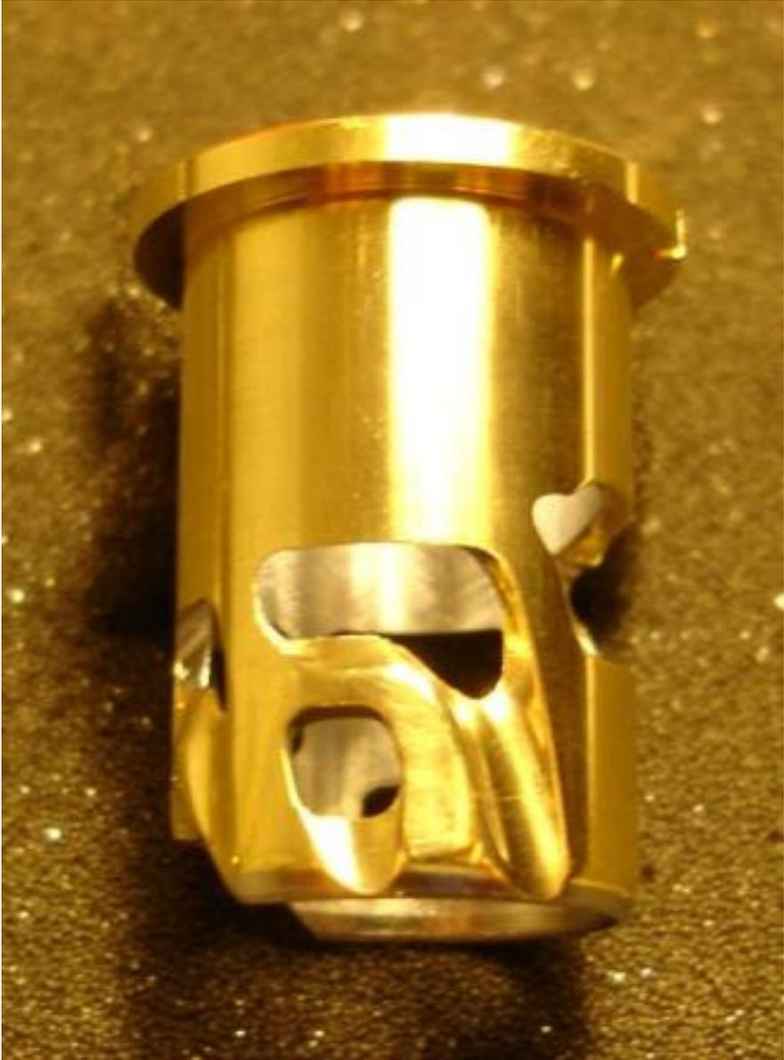
Cilindro – particolare della lavorazione dei travasi centrali – vista interna
