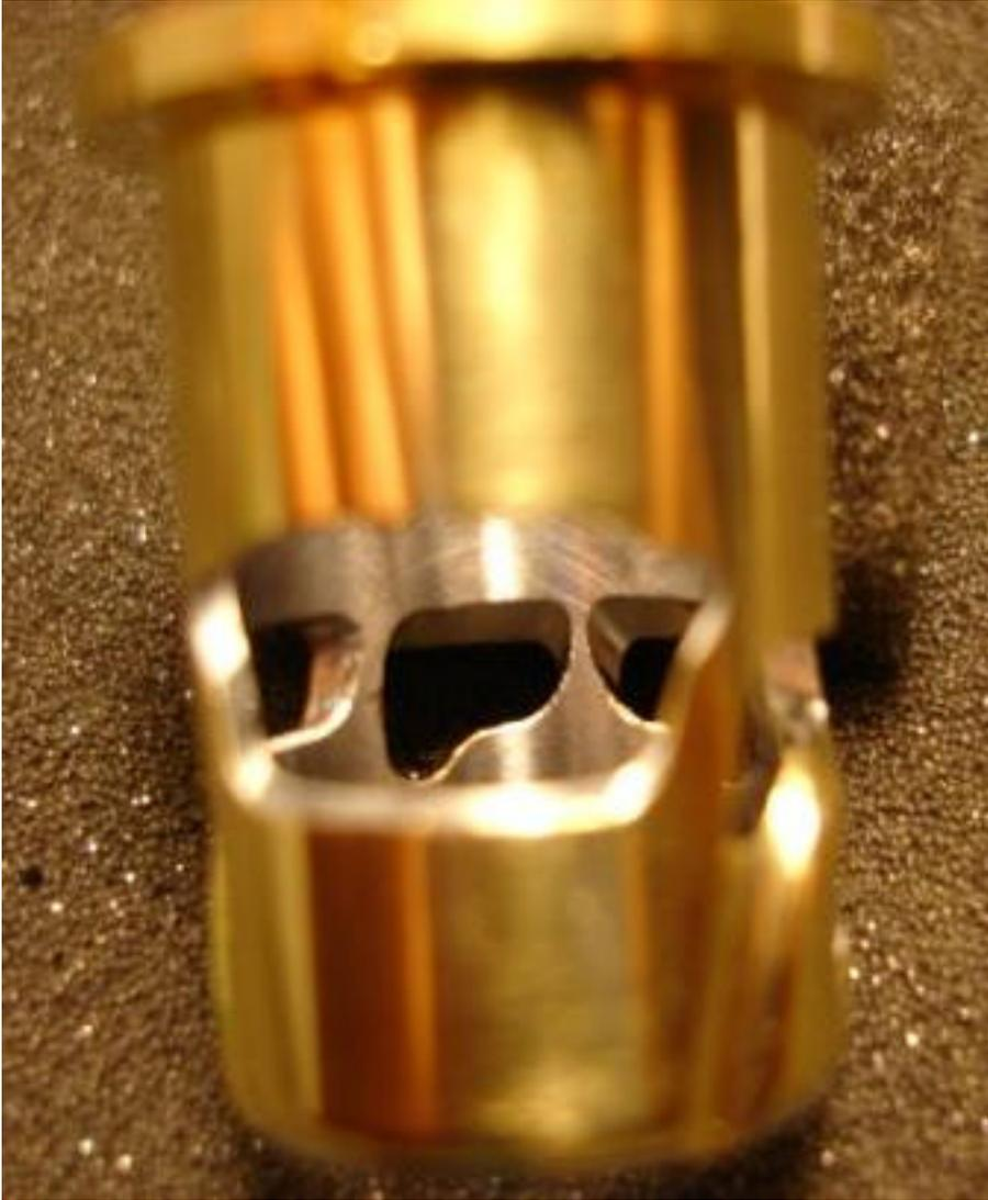
Cilindro – vista interna del travaso laterale
