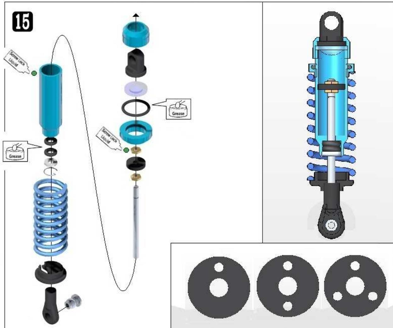
Procedere al montaggio degli ammortizzatori sul telaio.
