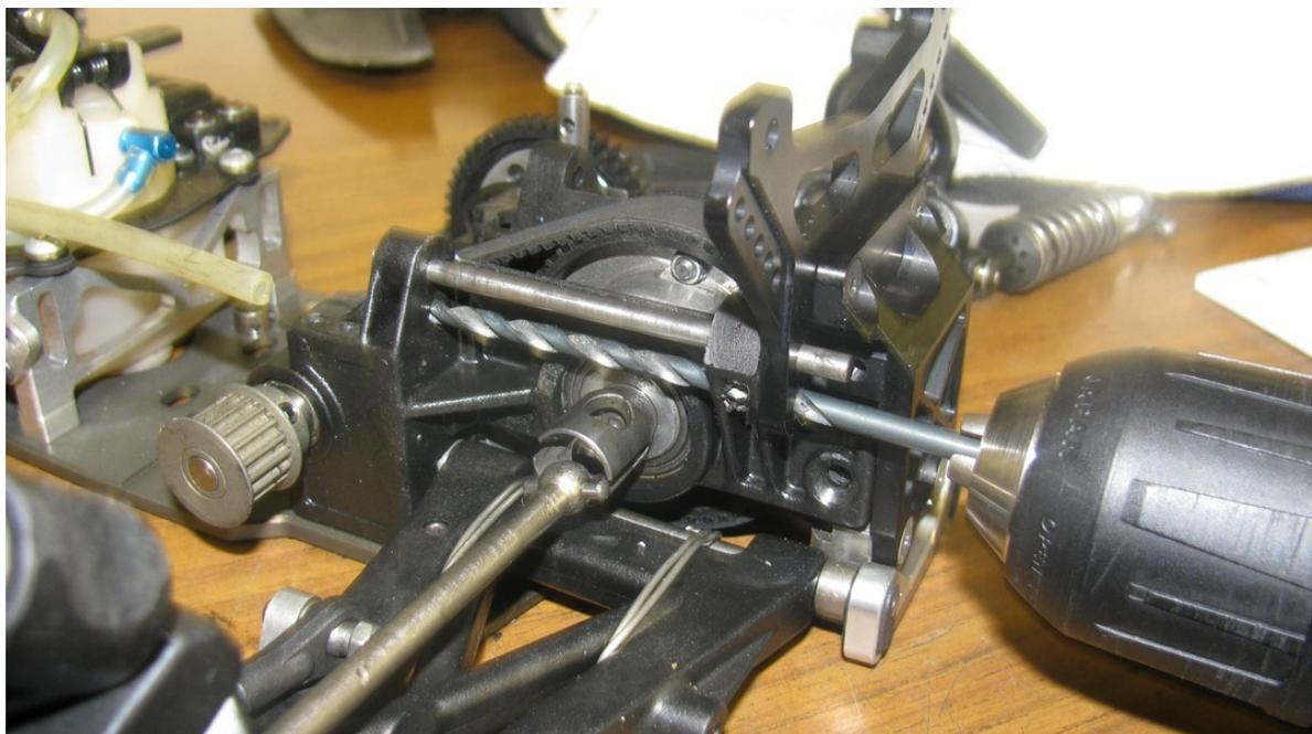
FASE 3 – CONSUMARE CON IL DREMEL LA BATTUTA DEL CUSCINETTO SU ENTRAMBE LE SPALLINE PER PERMETTERE L'ABBASSAMENTO DEL BRACCETTO SUPERIORE NELLA NUOVA POSIZIONE RIBASSATA
