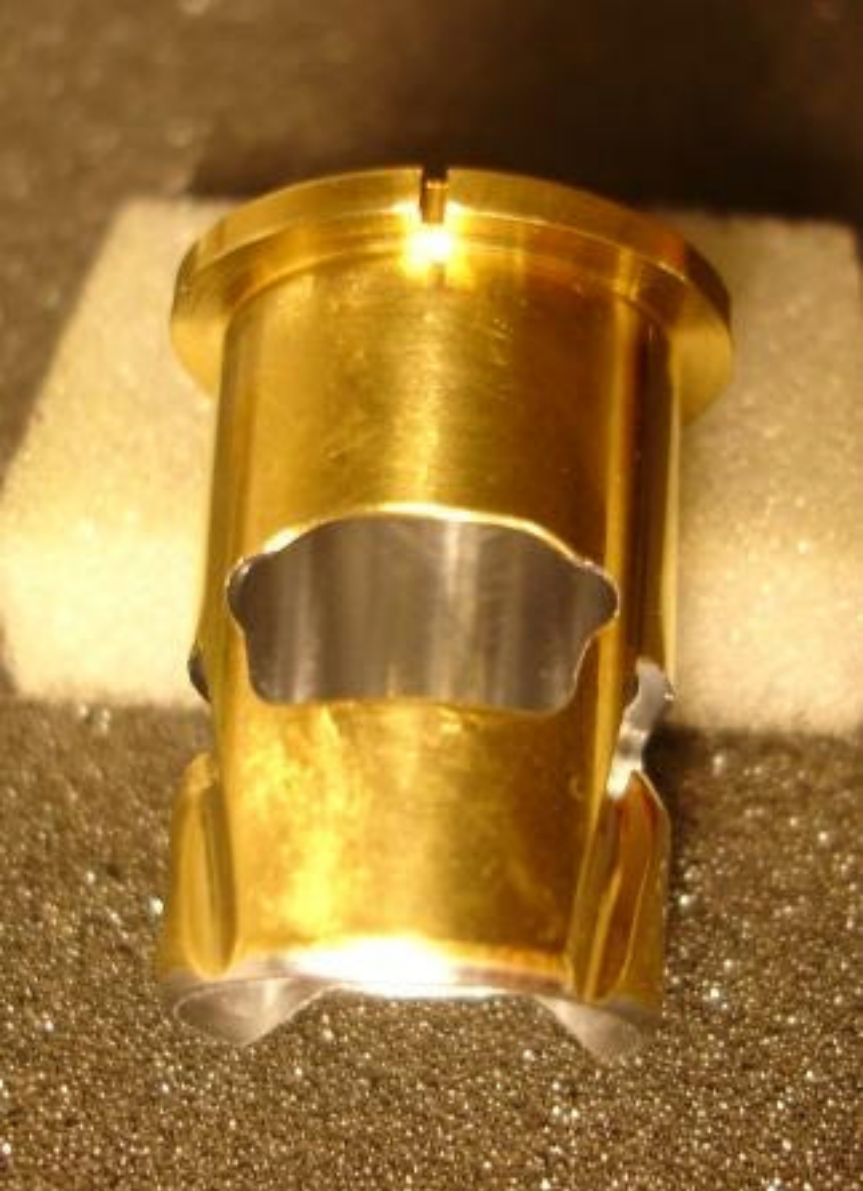
Cilindro vers. 2 – varia lo scarico e travasi
